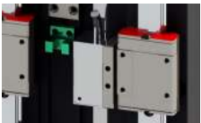
标配0.1μm分辨率光栅尺 全闭环控制
