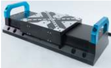
设计有标准安装及吊装接口 方便运输及使用
